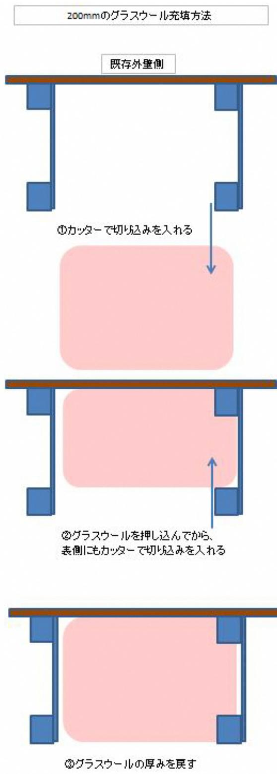
図6 グラスウールの施工手順
