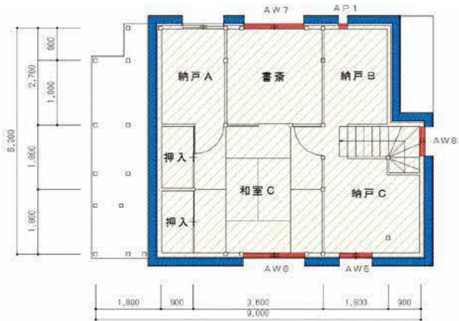
図2 平面図 (改修後)
